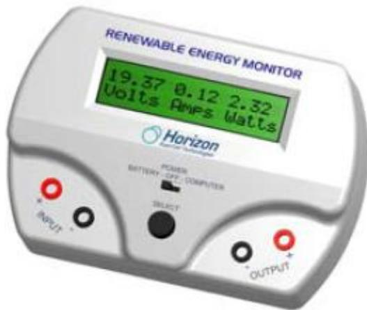
Existem dois conjuntos de terminais de **Entrada (Input)** e **Saída (Output)**. Os terminais de Entrada ficam do lado esquerdo e os terminais de Saída ficam do lado direito do dispositivo. O terminal em Vermelho é o positivo (+) e o terminal em Preto é o negativo (-). Você deve observar a polaridade correta nos terminais quando for fazer a conexão com pilhas, painéis solares, aerogeradores ou células a combustível.
